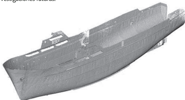
Fig. 6. ILA, información del scanner 3D.
