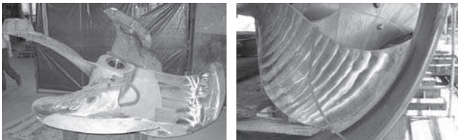
Fig. 23. Propulsor CLT nuevo para el buque ILA durante modificación y huelgas finales
